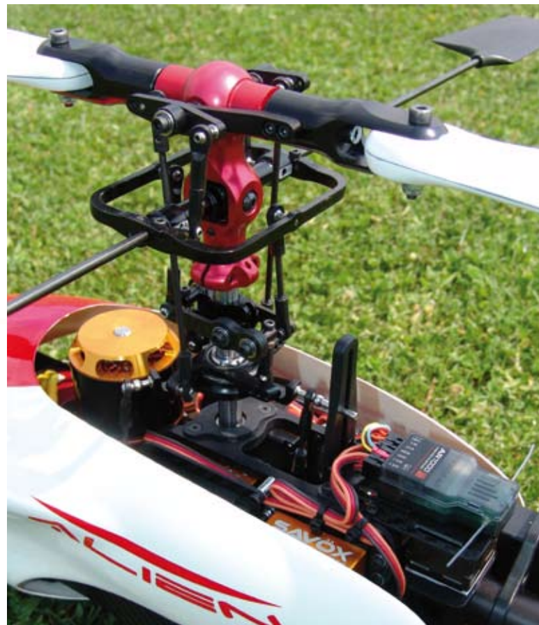
Der Paddelkopf des Alien 600 E-CF ist mit seiner unten liegenden Paddelstange konventionell aufgebaut. Das Mischverhältnis des Bell-Hiller-Mischers ist durch Umsetzen eines Kugelkopfes in Grenzen einstellbar
