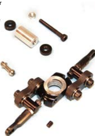
Der Mitnehmer für den Taumelscheiben-Innenring wird auf der Hauptrotorwelle festgeklemmt. Seine (recht kurzen) Arme sind vollständig kugelgelagert
